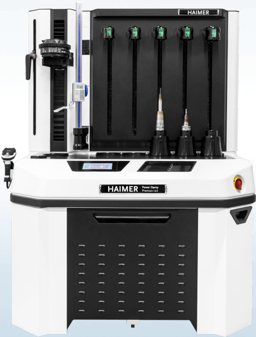
Abbildung zeigt 80.180.00NG mit Längenvoreinstellung und Scanner (optional) Picture shows 80.180.00NG with length presetting and scanner (optional)
